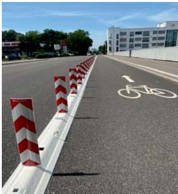
aus Recycling-Kunststoff. Durch Vater/Muttersystem einfachste Verlegung und Demontage. Einzelelemente sind mit Spezialhaken problemlos ausbaubar. Leitfahnen und Reflektoren einfach von oben einsteckbar. BASt-geprüft
