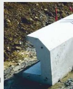
Nach Europäischer Norm EN206/1 und deutschen Anwendungsregeln nach DIN 1045/2 aus güteüberwachter, werkseitiger Fertigung, Betongüte C35/45 (Kein Sichtbetonanspruch; Maßtoleranzen nach DIN 18202; produktionsbedingte Farbunterschiede; vereinzelt Lunkerstellen bis Durchmesser ca. 5 mm).
