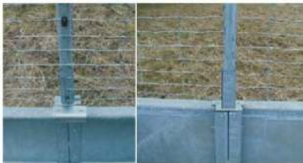
Adapter für Wildschutzzaun Standardausführung für Rundrohr 1 1/4 Zoll; Höhe 150mm Stand sichere Befestigung im Doppel-U-Pfosten der Amphibienleiteinrichtung
