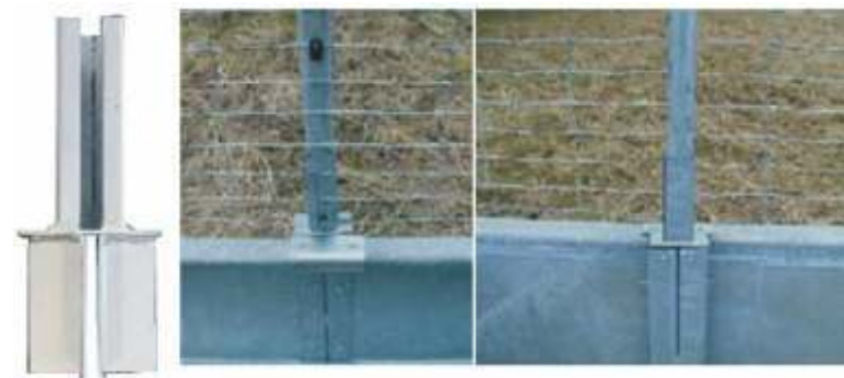
Adapter für Wildschutzzaun Standardausführung für Rundrohr 1¼ Zoll; Höhe 150mm Stand sichere Befestigung im Doppel-U-Pfosten der Amphibienleiteinrichtung
